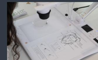
Ce visualiseur de bureau dispose d'une large plateforme de la taille d'un A3 vous permettant de visualiser entièrement la page d'un document.
