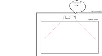
3. Utilisez un tournevis pour tourner le bouton rotatif dans le sens des aiguilles d'une montre jusqu'à ce qu'il soit bloqué. Vous verrez le faisceau laser toucher l'écran.
