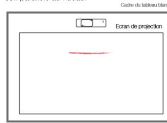
5. Ajustez le bouton rotatif pour permettre au faisceau laser de descendre à l'extérieur de l'écran de projection, en vous assurant que le faisceau laser et le rideau sont parallèles.
