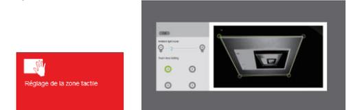
Si la calibration automatique échoue, un message d'erreur apparaît. Passez au réglage de la zone tactile.
