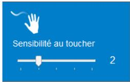
Si la fonction tactile devient moins sensible ou que l'écriture devient intermittente, il est possible d'augmenter la sensibilité en réglant le niveau de la sensibilité tactile.
