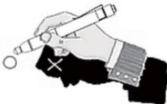
L'angle d'écriture entre la pointe du stylet et l'écran doit être inférieur à 75°.
