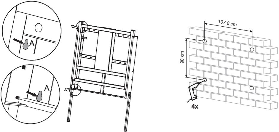
b) Cloison sèche / Plâtre - utiliser les trous A et B
