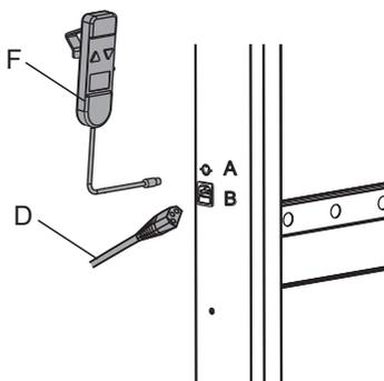
1. Vérifier la tension de votre réseau électrique. La tension doit correspondre à celle indiquée sur l'étiquette grise située sur le côté gauche du support.
