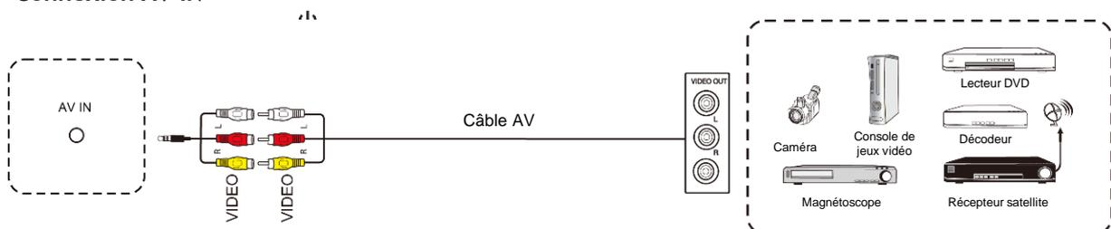
1. Utilisez les câbles AV audio et vidéo pour connecter à la prise « AV IN » de l'écran les équipements audio et vidéo pourvus d'une sortie AV (jaune pour la vidéo, rouge pour le canal sonore droit et blanc pour le canal sonore gauche).
