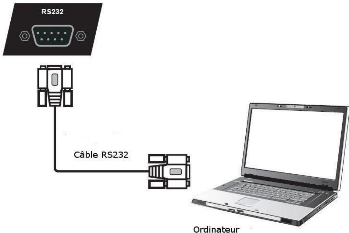
Connectez l'ordinateur au port série (RS232) de l'écran avec le câble RS232 correspondant (*non fourni*). Après avoir utilisé la ligne de port série RS232 pour connecter un équipement de commande et l'écran, certaines fonctions peuvent être contrôlées via l'équipement de contrôle central : allumer/éteindre, ajuster le volume sonore...
