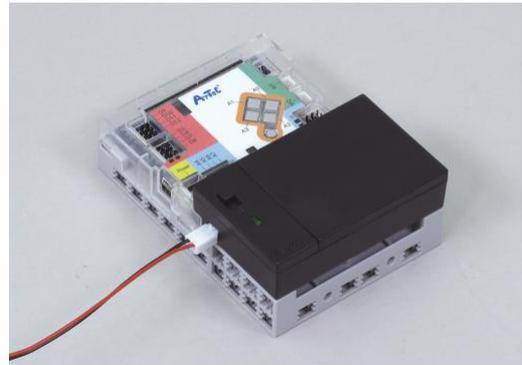
② Branche la batterie sur le connecteur Power de ton Studuino.
