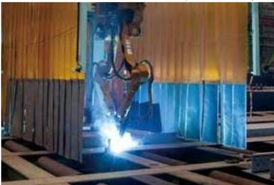
Tu peux utiliser ce qu'on appelle la soudure pour joindre deux pièces de métal rapidement et précisément.
