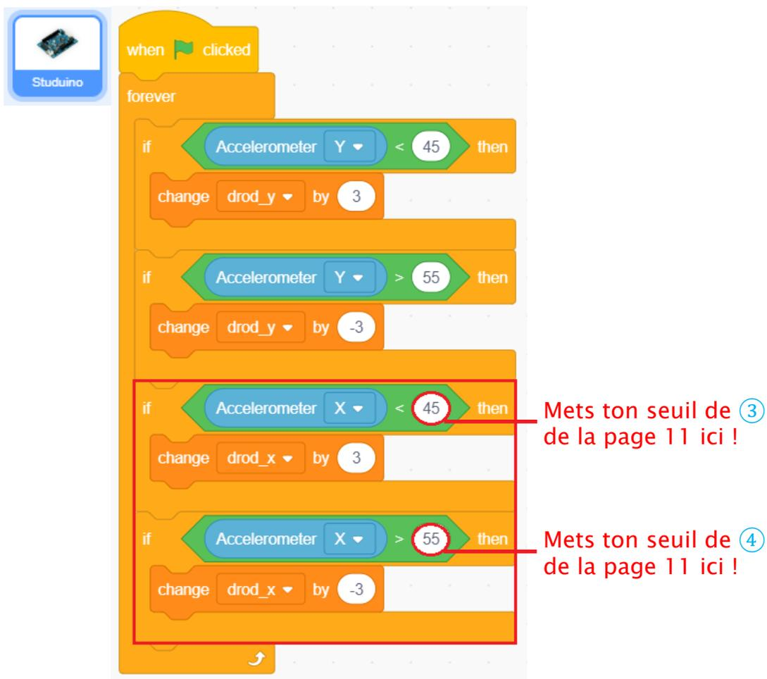
④ Connecte ton Studuino pour voir comment ton programme fonctionne. Si tu as du mal à déplacer Drod, ajuste tes seuils.
