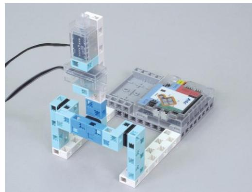
⑮ Branche ton capteur tactile sur A0 et ton accéléromètre sur A4/A5.
