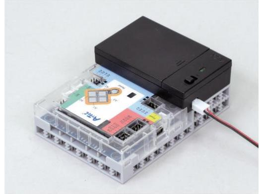
⑫ Branche la batterie sur le connecteur **Power** de ton Studuino.
