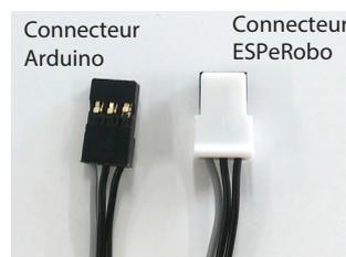
Nos pièces peuvent être connectées à la carte. Les câbles de connexion pour les capteurs et les servomoteurs n'ont pas de fiches réversibles.
